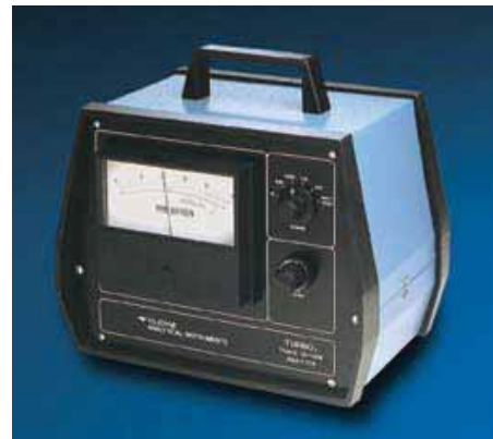
Недорогой аналоговый анализатор серии TURBO2 для измерения следового кислорода
