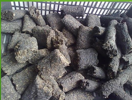
Брикеты из опилок и цементного раствора (утеплитель)
