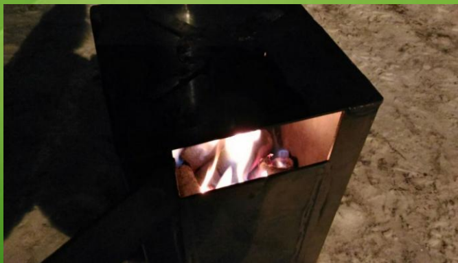
Горение брикетированного ила очистных сооружений в печи
