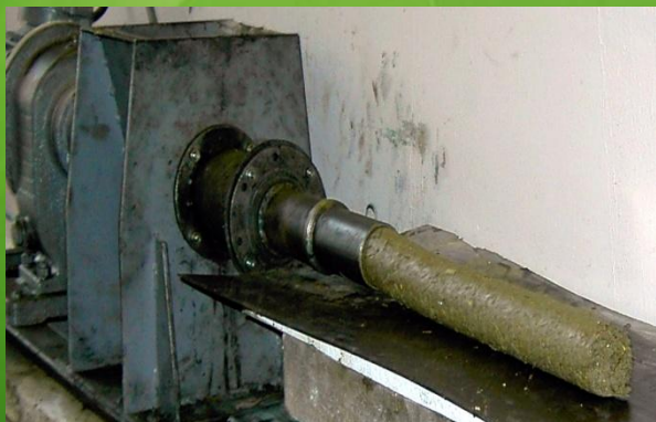
Экструдирование формовочной массы в кормовые брикеты на шнековом прессе
