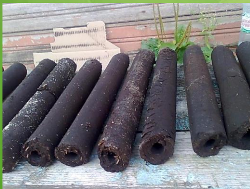
Торфобрикеты. Диаметр – 53 мм.
